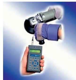
6. attēls. Plaukstu – roku vibrācijas mērīšana.
