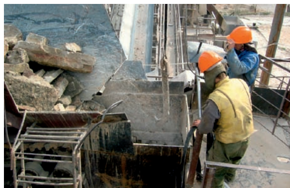
3.4. attēls. Akmens drupināšanas process.
