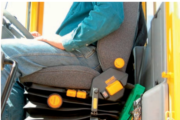
9. attēls. Vibrāciju amortizējošs transporta līdzekļa vadītāja sēdeklis.
