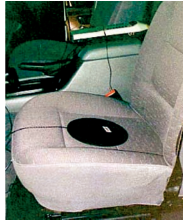
8. attēls. Visa ķermeņa vibrācijas mērīšana.
